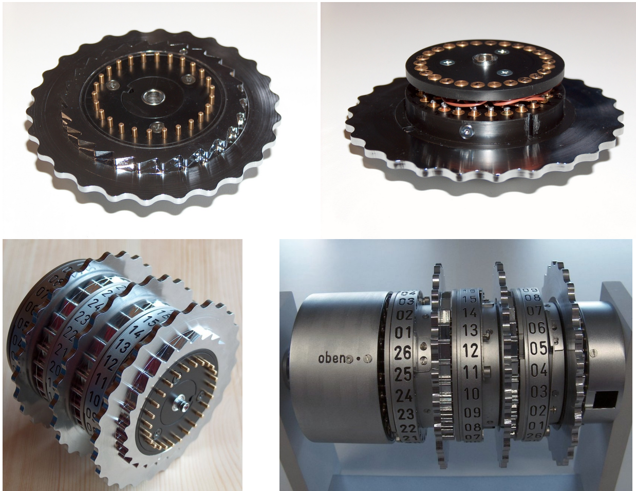
Abbildung 3: Die nach den vorliegenden Plänen gefertigten Walzen in Detailansichten und komplett montiert.
